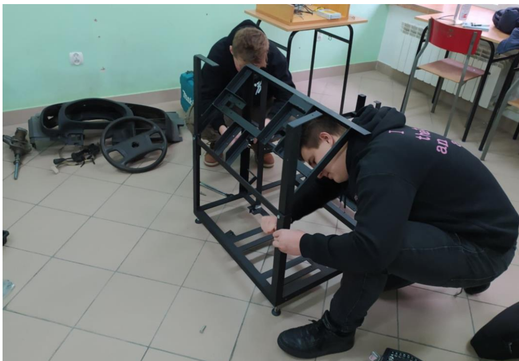
Rys. 7 Proces skręcania dolnej i środkowej części ramy
