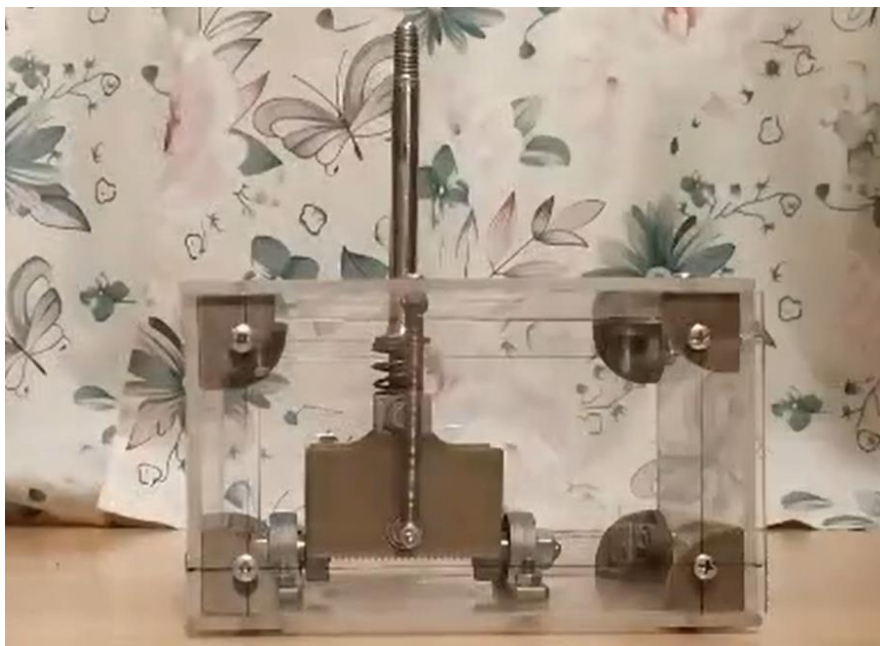
Rys. 14 Zmontowany mechanizm skrzyni biegów.
