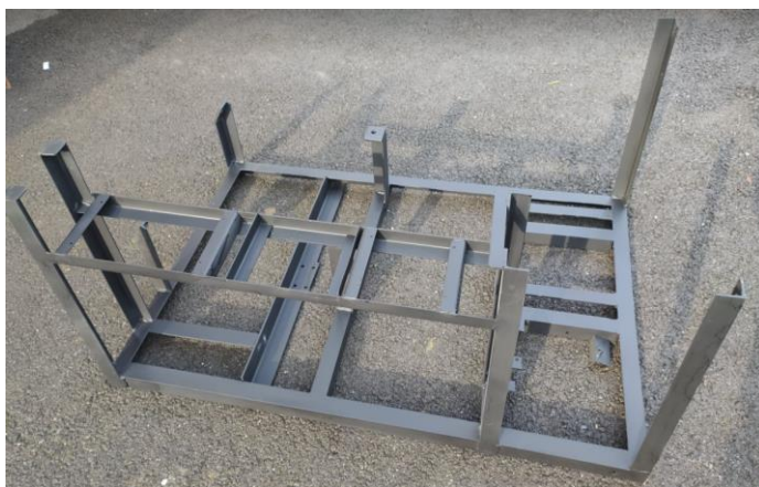
Rys. 5 Pospawane i pomalowane elementy ramy
