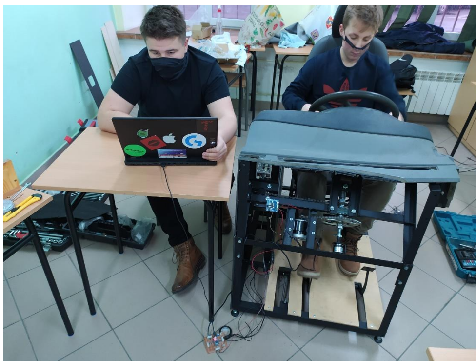
Rys. 46 Kalibracja potencjometrów pedałów
